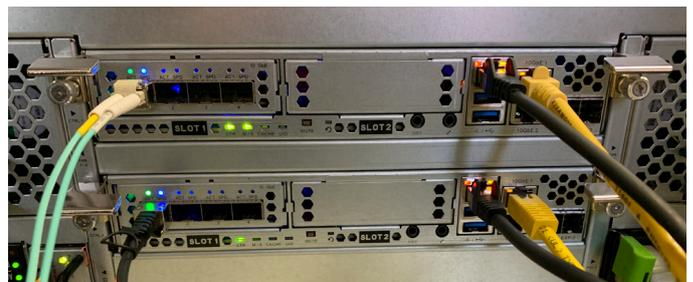
Figura 3: Dos conexiones SFP+ 10GB/s (izquierda) junto con la LAN 10GbE (cables amarillos) y los puertos (derecha) de gestión 1GbE (cables negros).
